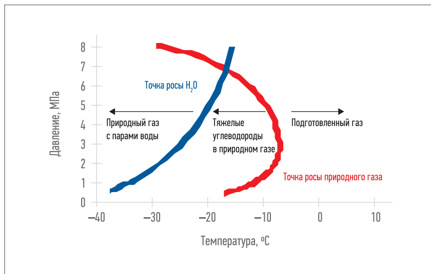
Рис. 1. Фазовая диаграмма природного газа с парами воды (синяя линия) и тяжелых углеводородов (красная линия)
